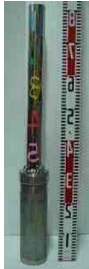
洗掘測定装置
