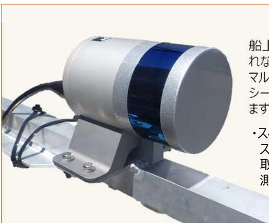
船上に搭載することで通常では測れない施設の計測が可能となり、マルチビームと同時計測することでシームレスな点群データを提供します。
