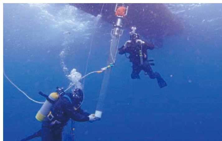
河床材料調査 (柱状採泥 VCS)
