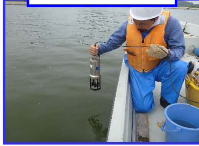
直読式水質計による 鉛直観測
