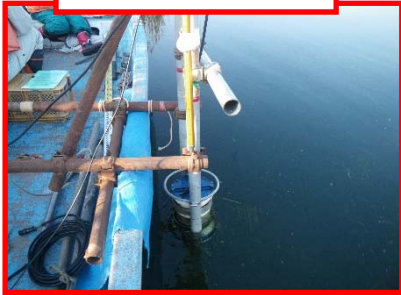
超音波流速計による 曳航観測
